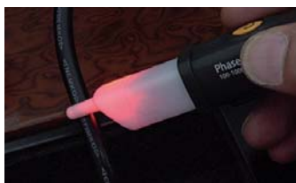
Encendido LED rojo con tensión detectada
