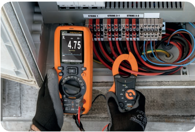
Módulos Fotovoltaicos: Medida de I mp .
