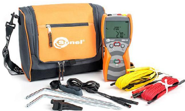
MRU-10 es un sencillo medidor que permite realizar mediciones por el método técnico, así como la medición de la resistencia de la puesta a tierra por el método bipolar. El aparato se caracteriza por su facilidad de manejo, su elevada resistencia a las perturbaciones y su gran precisión.
