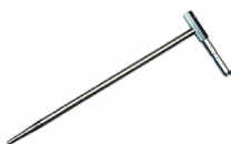
Sonda de medición para clavar en el suelo (30 cm)
