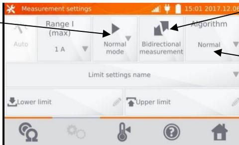
Commutación Medición Unidireccional/Medición Bidireccional.
