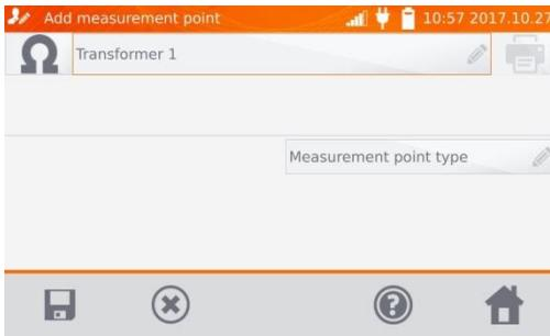
Al hacer clic en **Tipo del punto de medición** se puede seleccionar el tipo por defecto o introducir su propio tipo. Al registro se puede introducir una descripción adicional como para el objeto.
