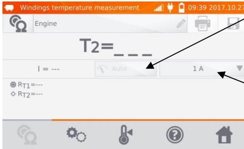
La forma de proporcionar la corriente de medición es fija en modo Auto, la corriente de medición está limitada al valor no mayor del valor establecido.
