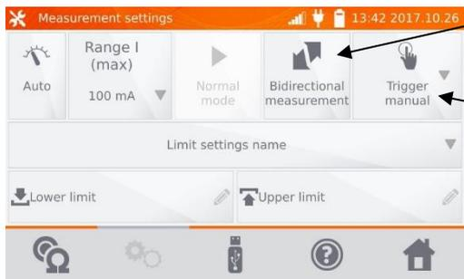
Comutación Medición Unidireccional/medición Bidireccional.
