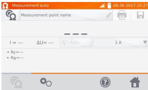
La medición es similar a los objetos de inducción. El medidor termina más rápidamente la medición si considera que el objeto tiene el carácter de resistencia, basándose en la diferencia entre la resistencia instantánea y la resistencia media durante la estabilización del resultado.
