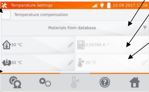
Activación/desactivación de la compensación de temperaturas
