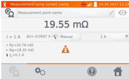
Además de resistencia, el medidor también muestra el valor de corriente medida con la pinza.
