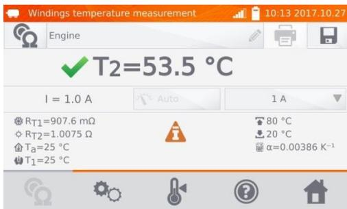
$R_{T1}$  – resistencia del bobinado frío
