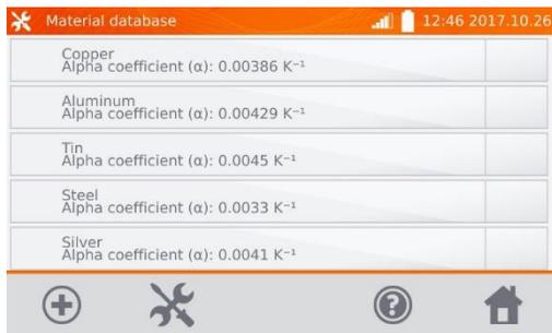
De fábrica están guardados 5 materiales predeterminados con coeficientes térmicos de resistencia: cobre, aluminio, estaño, acero y plata. Con el botón
