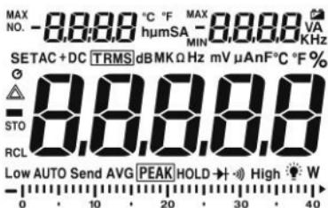
Pantalla de cristal líquido del medidor CMM-40
