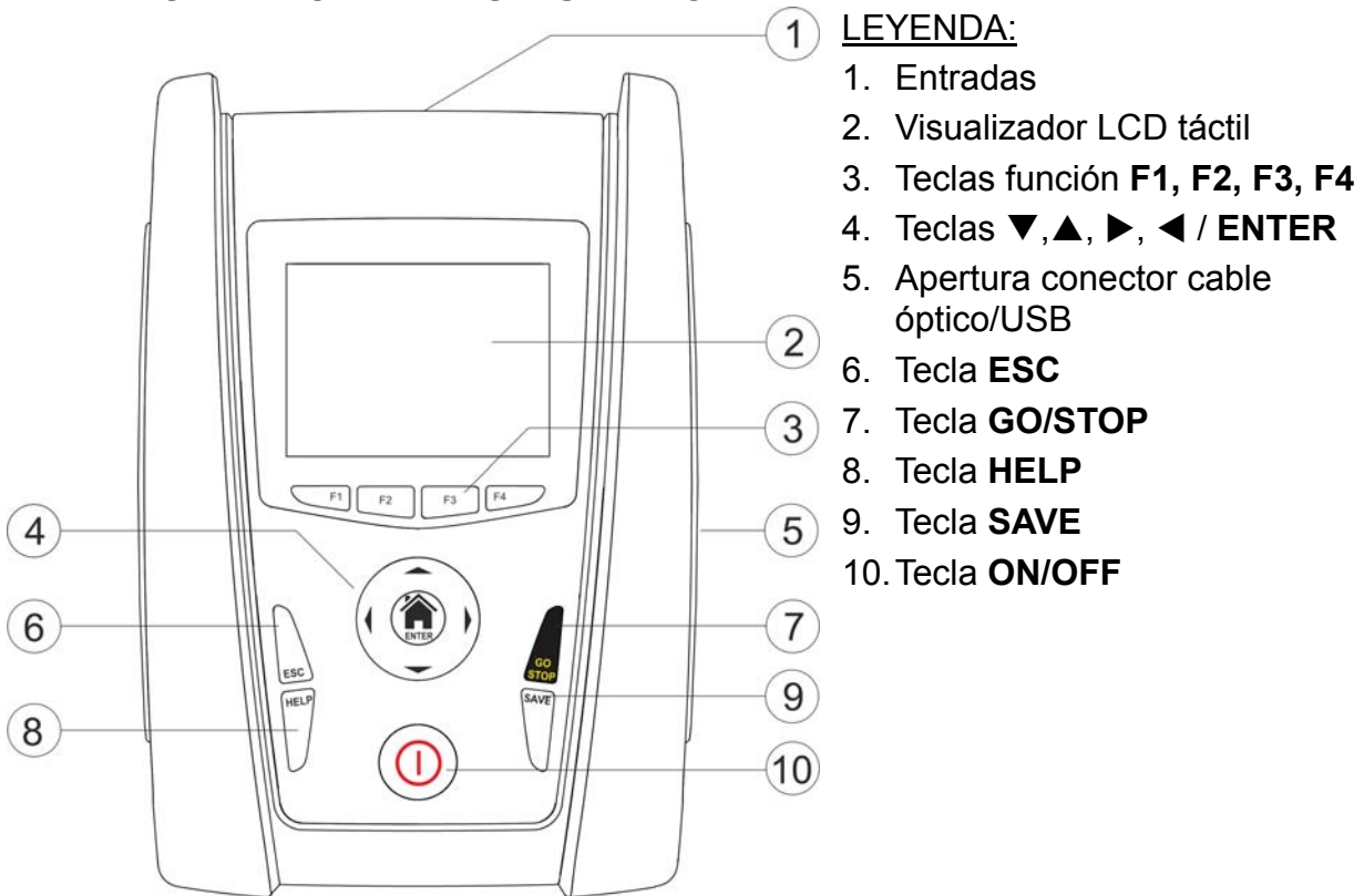
Fig. 1: Descripción parte frontal del instrumento
