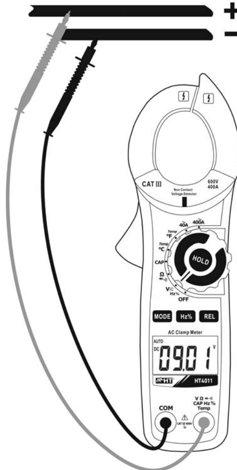
Fig.2: Uso de la pinza en medida de Tensión CC
