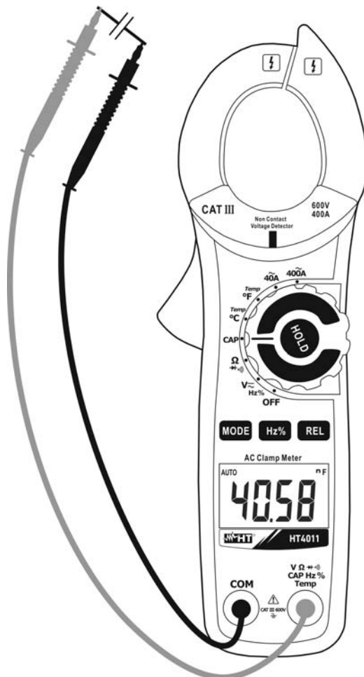
Fig. 6: Uso de la pinza para medida de Capacidades
