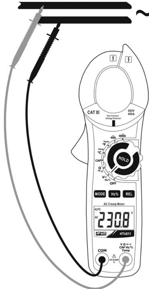
Fig. 3: Uso de la pinza en medida de Tensión CA
