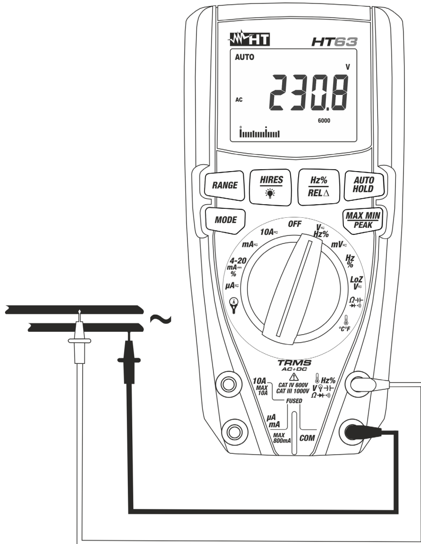
Fig. 3: Uso del instrumento para medida de Tensión CA
