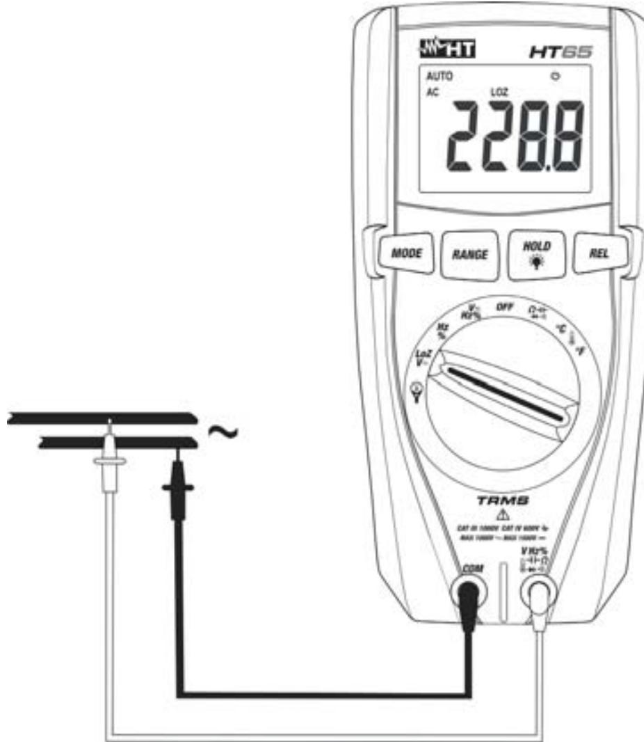
Fig. 4: Uso del instrumento para medida de Tensión CA/CC con función LoZ
