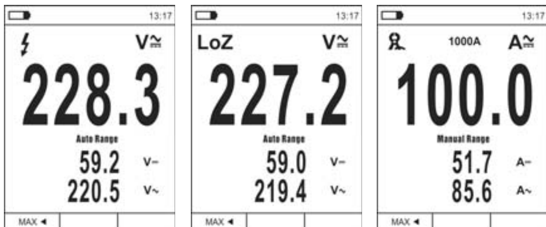
Fig. 6: Descripción medida tensión y corriente CA+CC
