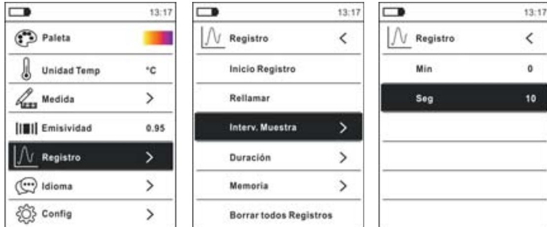
Fig. 35: Función data logger – Configuración frecuencia de muestreo
