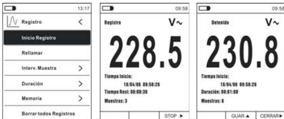
Fig. 37: Función data logger – Inicio y Fin registro
