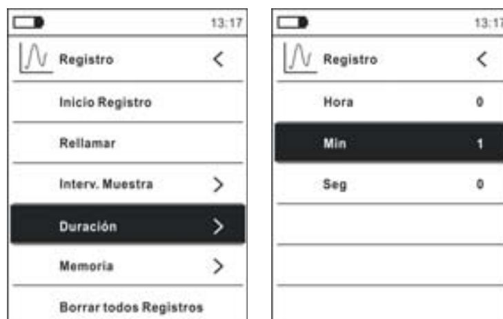
Fig. 36: Función data logger – Configuración duración registro
