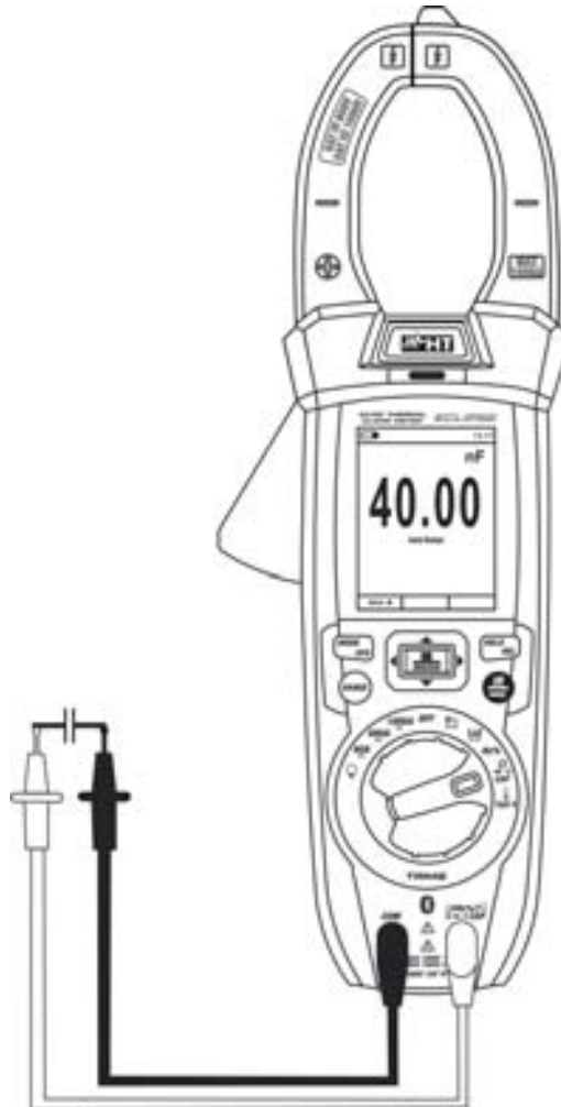
Fig. 29: Uso del instrumento para medida de Capacidades
