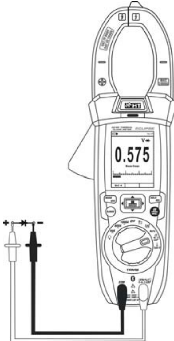
Fig. 28: Uso del instrumento para la Prueba de Diodos
