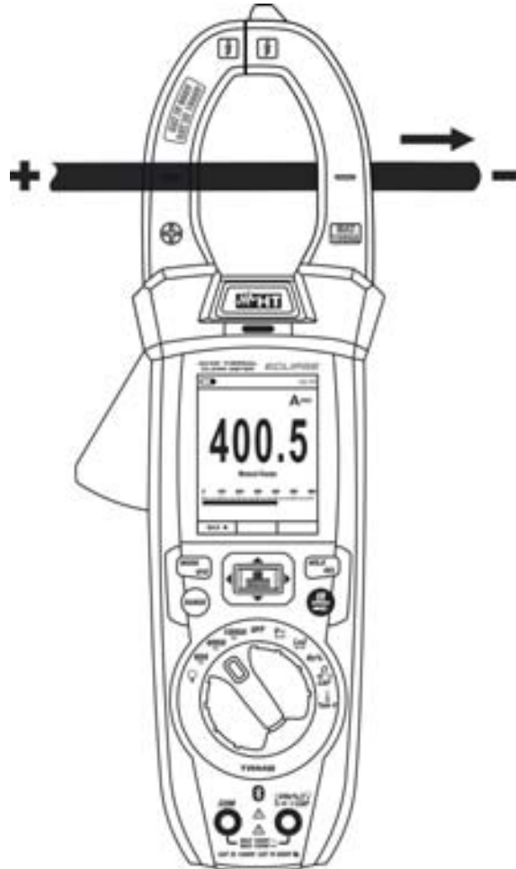
Fig. 31: Uso del instrumento para medida de Corriente CC
