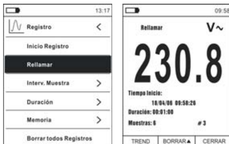
Fig. 38: Función data logger – Rellamada en pantalla datos registro
