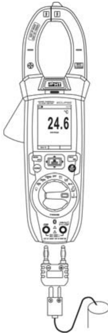
Fig. 30: Uso del instrumento para medida de Temperatura
