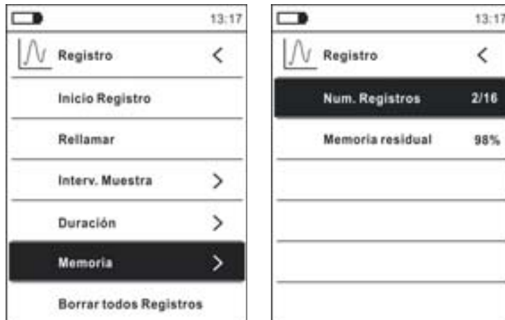
Fig. 41: Función data logger – Contenido memoria
