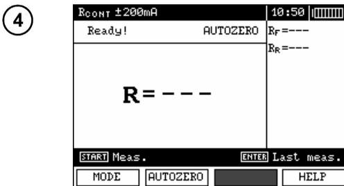
Aparece el texto **AUTOZERO** que significa que se ha hecho la calibración de los cables de medición.
