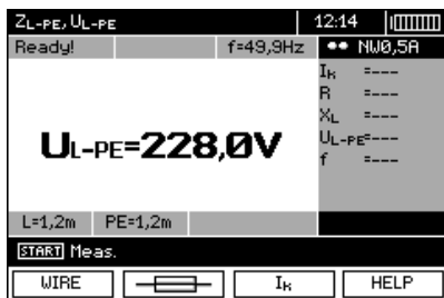
Comprobación de la eficacia de la protección contra electrochoques de la carcasa del dispositivo en caso de: a) la red TN b) la red TT
