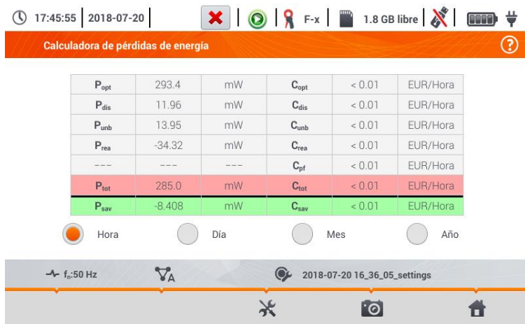
Fig. 5.28 Análisis de las pérdidas de energía
