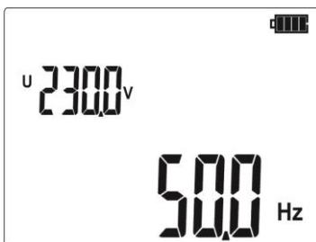
Leer el resultado de la medición: la tensión en la pantalla adicional, la frecuencia en la pantalla principal.
