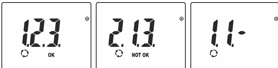
Fig. 14: Resultados de la prueba de secuencia y concordancia de las fases
