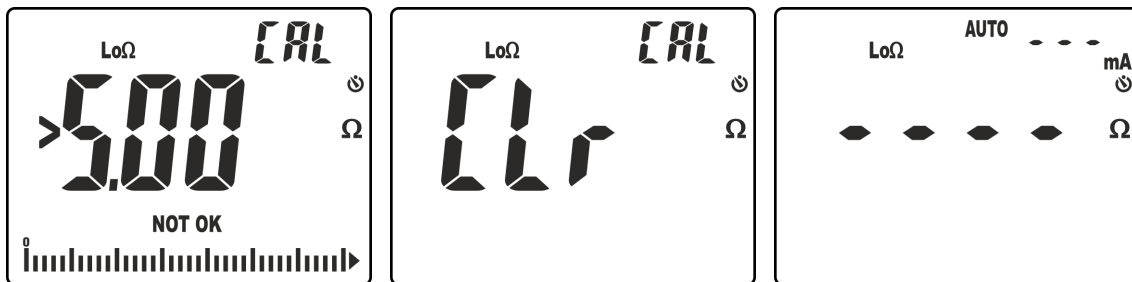
Fig. 34: Resultados puesta a cero no realizada correctamente
