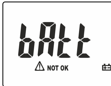
Fig. 43: Pantalla con indicación pilas descargadas
