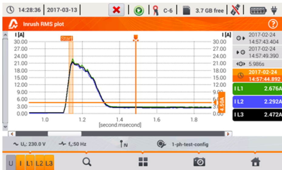
Fig. 43. Análisis de la corriente de arranque - gráficos de los valores eficaces de medio período.
