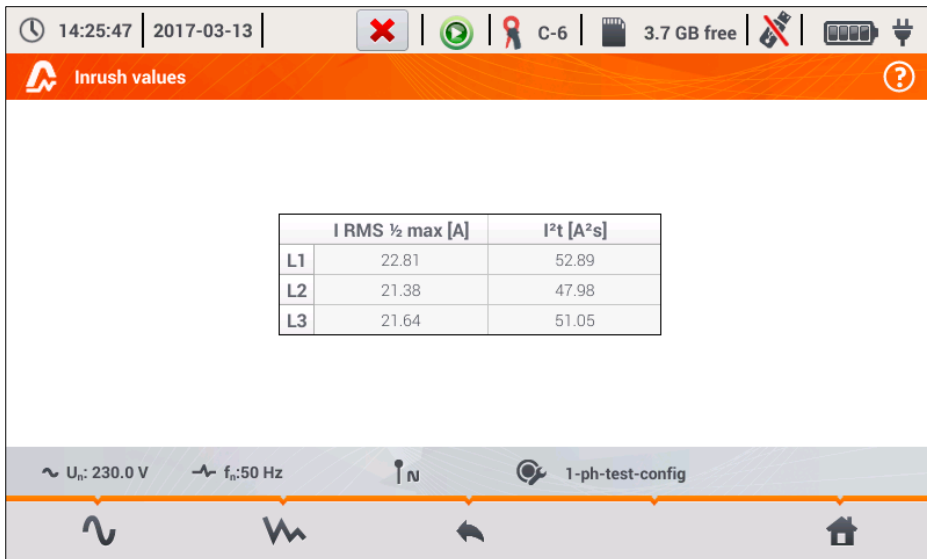
Fig. 44. Corriente de arranque - parámetros característicos.
