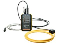
Permite la medición de puestas a tierra de torres de transporte de energía eléctrica.
