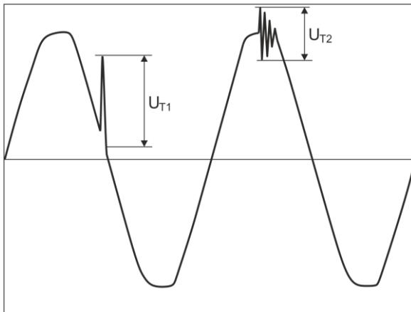
Fig. 36. Método para determinar las amplitudes de transientes.
