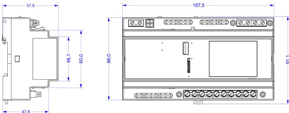
**Fig. 4. Dimensiones externas del analizador (en milímetros).**
