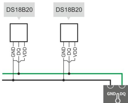
Fig. 33. Conexión de sensores de 1-wire al PQM-750.
