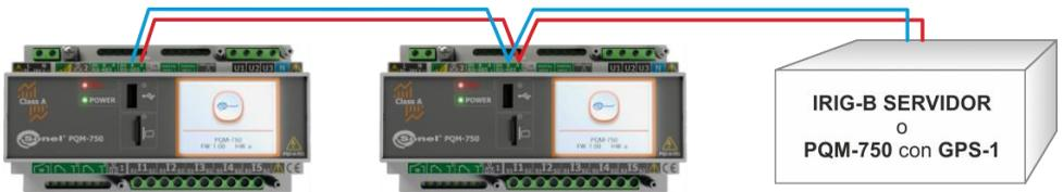
**Fig. 32. Ejemplo de red de sincronización IRIG-B**
