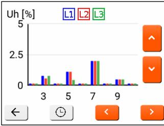
Fig. 14. Pantalla de tensiones armónicas. Se muestran 9 armónicos en cada pantalla y presionar las flechas hacia arriba y hacia abajo permite pasar a los 9 armónicos siguientes o anteriores. Pulsando la flecha derecha se pasa a corrientes armónicas.
