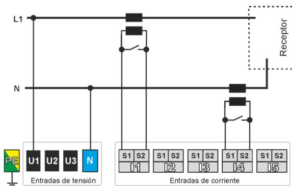
Fig. 25. Esquema de conexión – sistema monofásico, conexión directa de tensiones.
